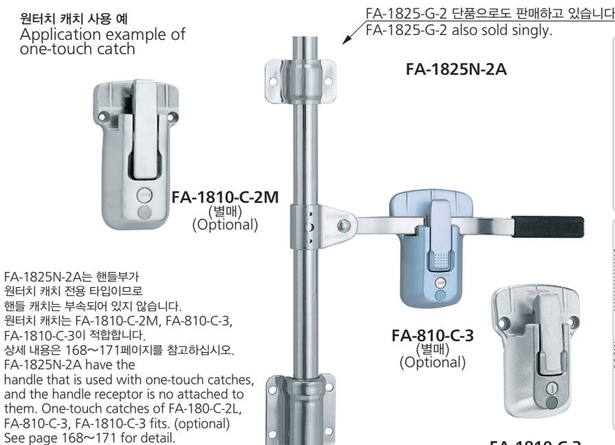
FA-1825N-2A는 핸들부가 원터치 캐치 전용 타입이므로 핸들 캐치는 부속되어 있지 않습니다. 원터치 캐치는 FA-1810-C-2M, FA-810-C-3, FA-1810-C-3이 적합합니다. 상세 내용은 168~171페이지를 참고하십시오. FA-1825N-2A have the handle that is used with one-touch catches, and the handle receptor is no attached to them. One-touch catches of FA-180-C-2L, FA-810-C-3, FA-1810-C-3 fits. (optional) See page 168~171 for detail.
