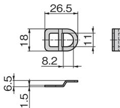
적용 핸들 단면 치수(최대) Applicable handle cross section dimension (max.)
