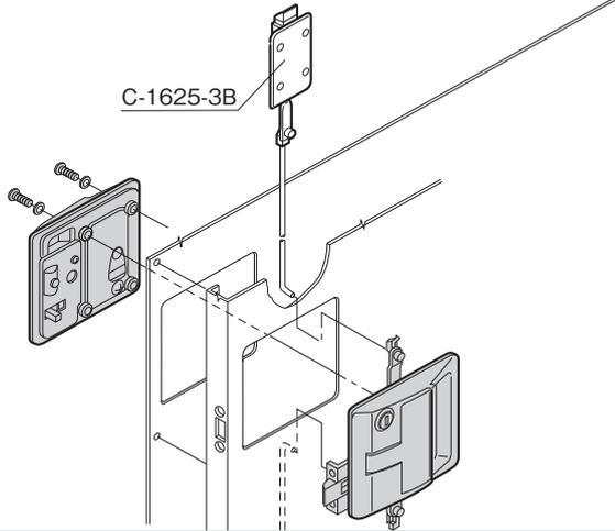
래치와의 조합에 의해서 3점 조임이 가능. 3-point securing lock in combination with the latch is available.
