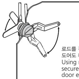
로드를 겸용하는 대형 도어도 확실하게 고정. Using rod together secures a large door easily.
