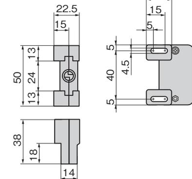
패널 구멍 치수 Panel drilling dimensions
